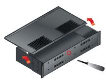
Otez le couvercle en le faisant glisser vers l'arrière. Retirez l'obturateur en le devissant en face avant.
